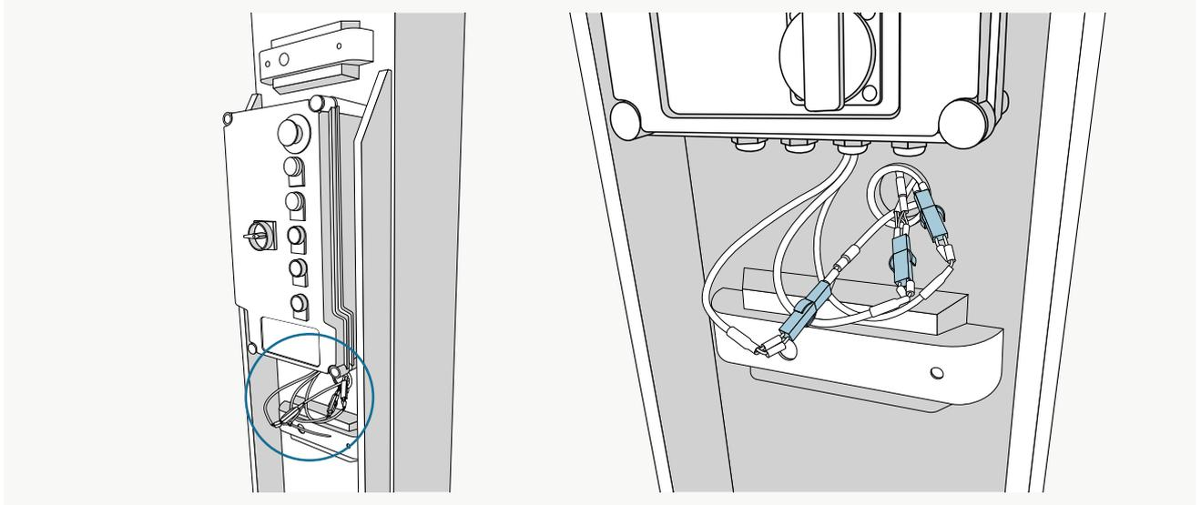
Die betreffenden Verbindungen verlaufen unterhalb des Bedienpultes in die Säule hinein.
