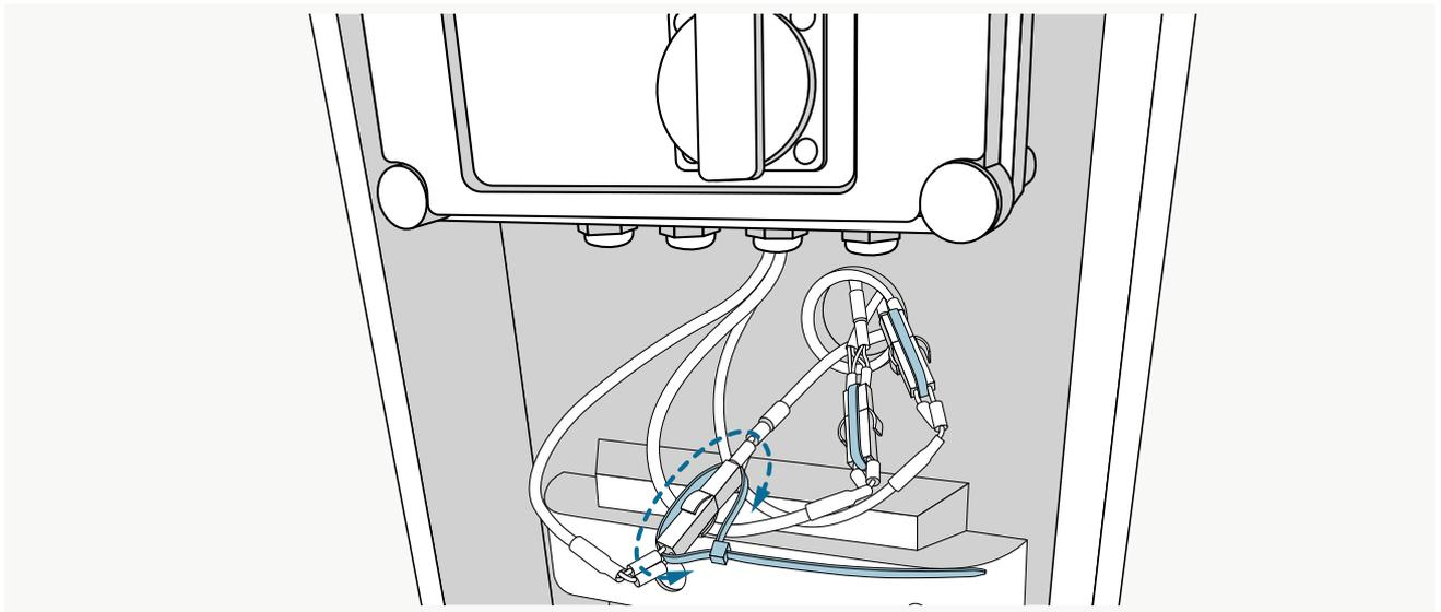
Sichern Sie die Verbindungsstücke, indem Sie Kabelbinder zwischen den Elektrokabeln durchziehen und zusammenklicken.
