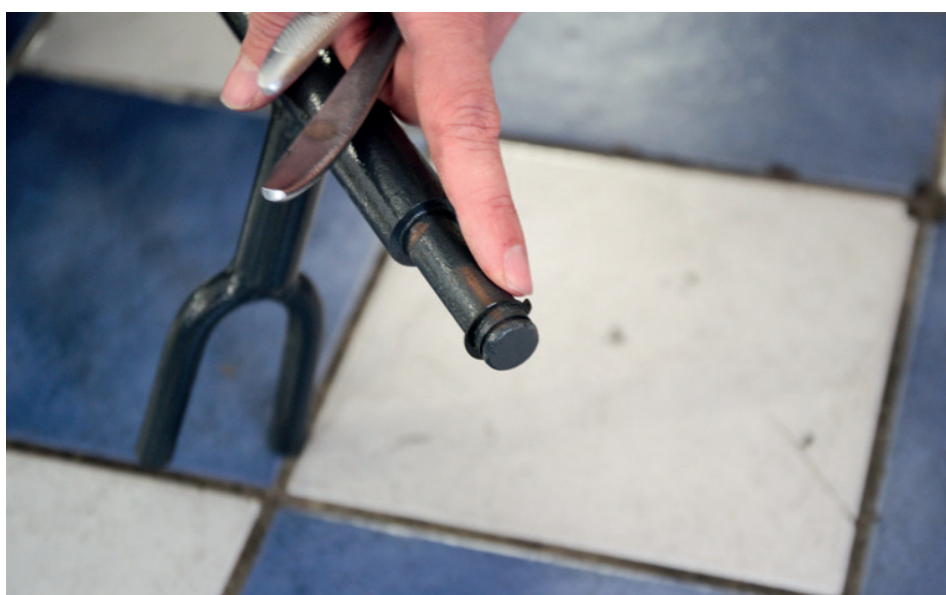
Position des Sicherungsring nach der Rollenmontage.
