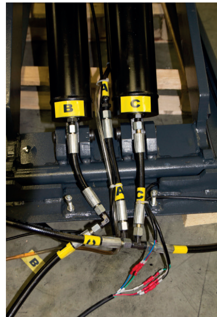
Ansicht einer korrekten Verkabelung zu den Plattformen:
