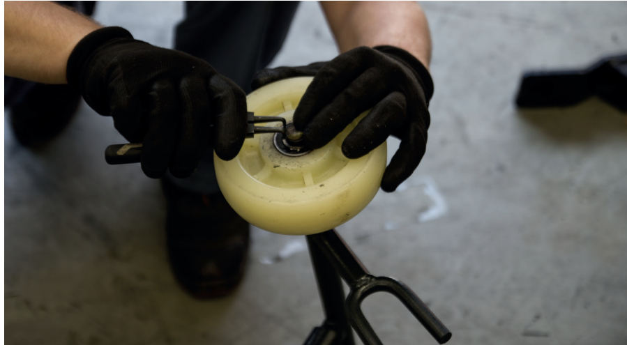
Montage der Fahrwerksrollen.
